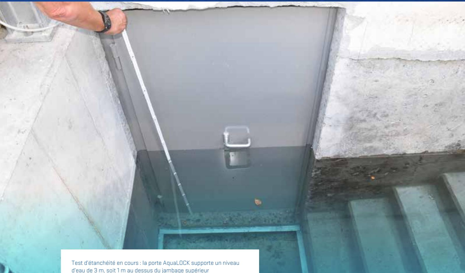
Test d'étanchéité en cours : la porte AquaLOCK supporte un niveau d'eau de 3 m, soit 1 m au dessus du jambage supérieur
